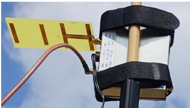
Bild: LZ5HP 2300 MHz ⇔ 430 MHz Transverter mit mitgelieferter Testantenne
