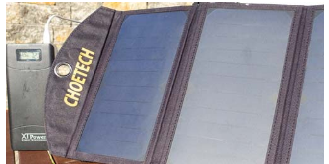
Bild 2: USB-gekoppeltes, dreiflügliges Solarmodul 540 g mit Powerbank 504 g
