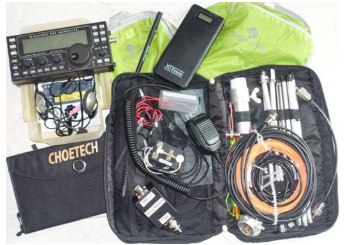
Bild 1: Portable-Ausrüstung mit Transceiver-Box 1380 g und Zubehörhülle 3180 g
